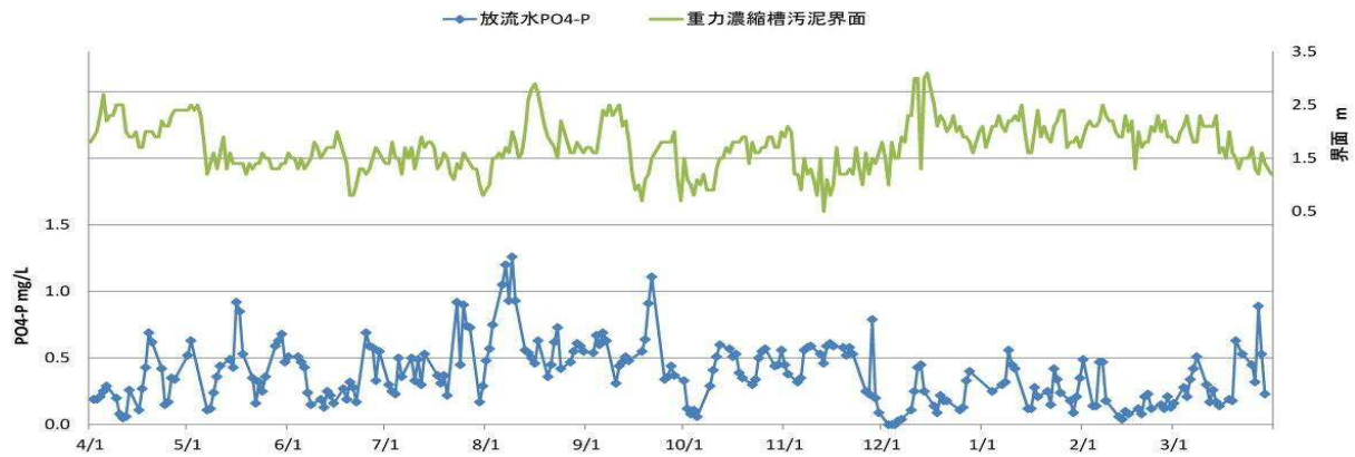
図-5 重力濃縮槽汚泥界面と放流水PO 4 -Pの関係
