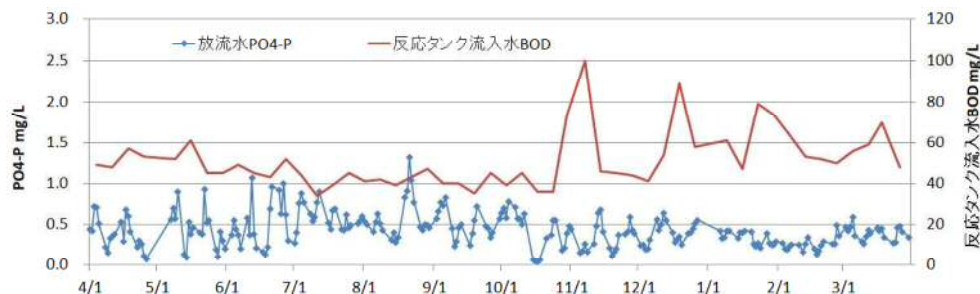
図-5 反応タンク流入水BODと放流水PO 4 -Pの関係
