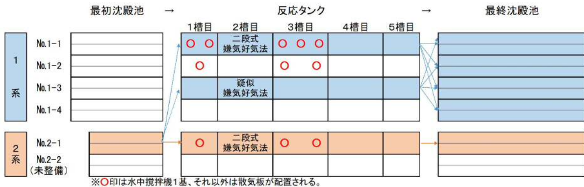
図-1 水処理施設の使用状況と処理方式
