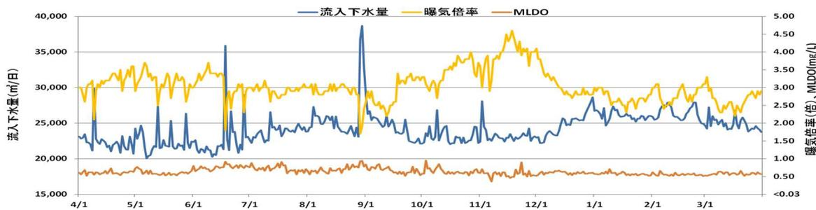
図6 流入下水量、曝気倍率、MLDOの推移(R6)
