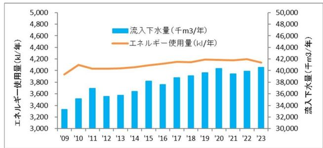
図1 流域下水道事業のエネルギー使用量の推移
