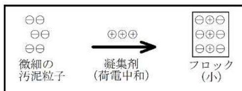
図 2 高分子凝集剤の作用機構（凝結反応）
